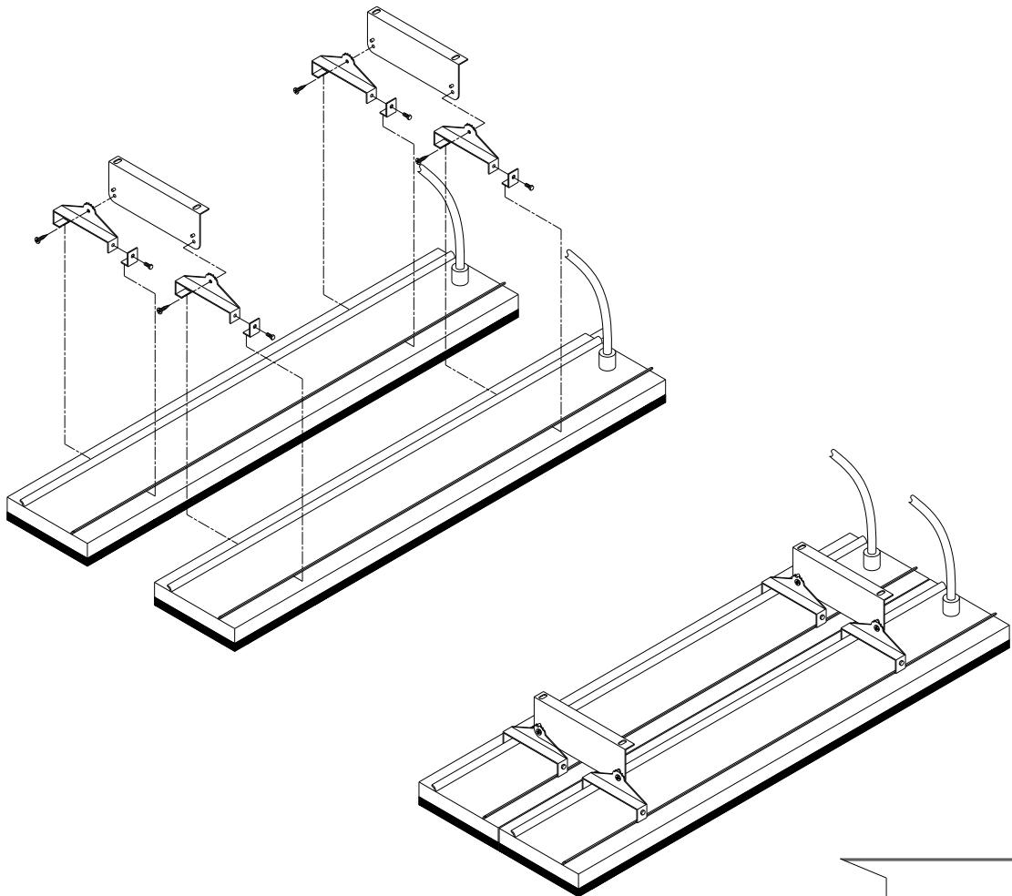
Le support de fixation jumelé permet d'installer deux (2) unités HEATSTRIP Design côté à côté, parallèlement ou en oblique, comme le montre le diagramme de droite. Cette solution convient tout particulièrement lorsque la situation
