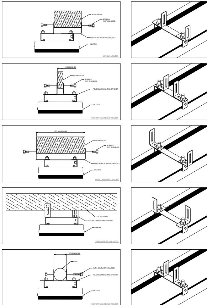
Le kit optionnel de fixation sur poteau/poutre peut être utilisé pour installer le HEATSTRIP Design sur des poutres en bois, des chevrons, des poteaux, des mâts de parasol, etc.
