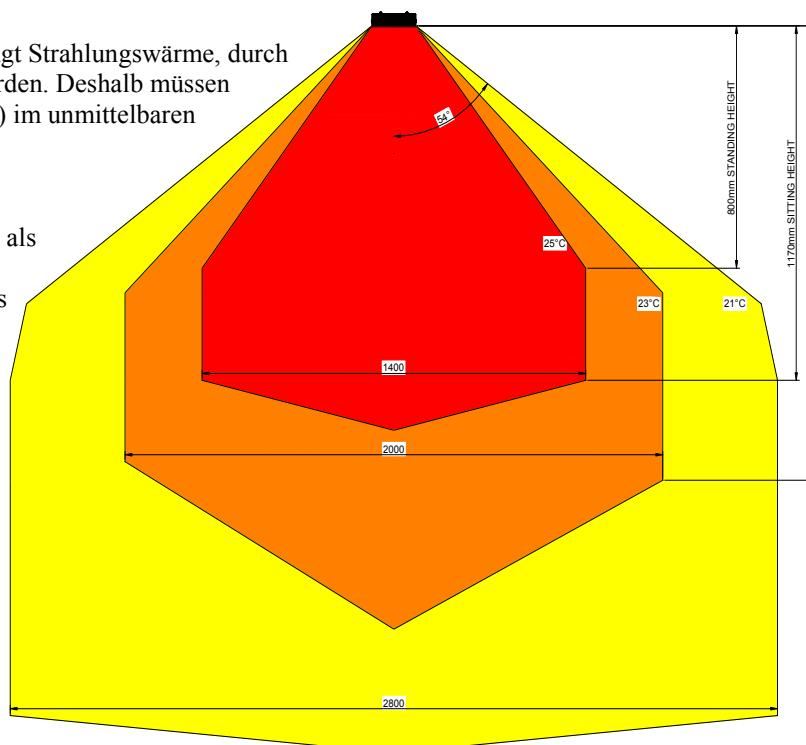
Die nachfolgenden Diagramme zeigen den ungefähren Strahlungsbereich für jedes Modell, sowohl bei Innenbereichen als auch bei eingefassten Außenbereichen, mit direkter Überkopf-Montage.
