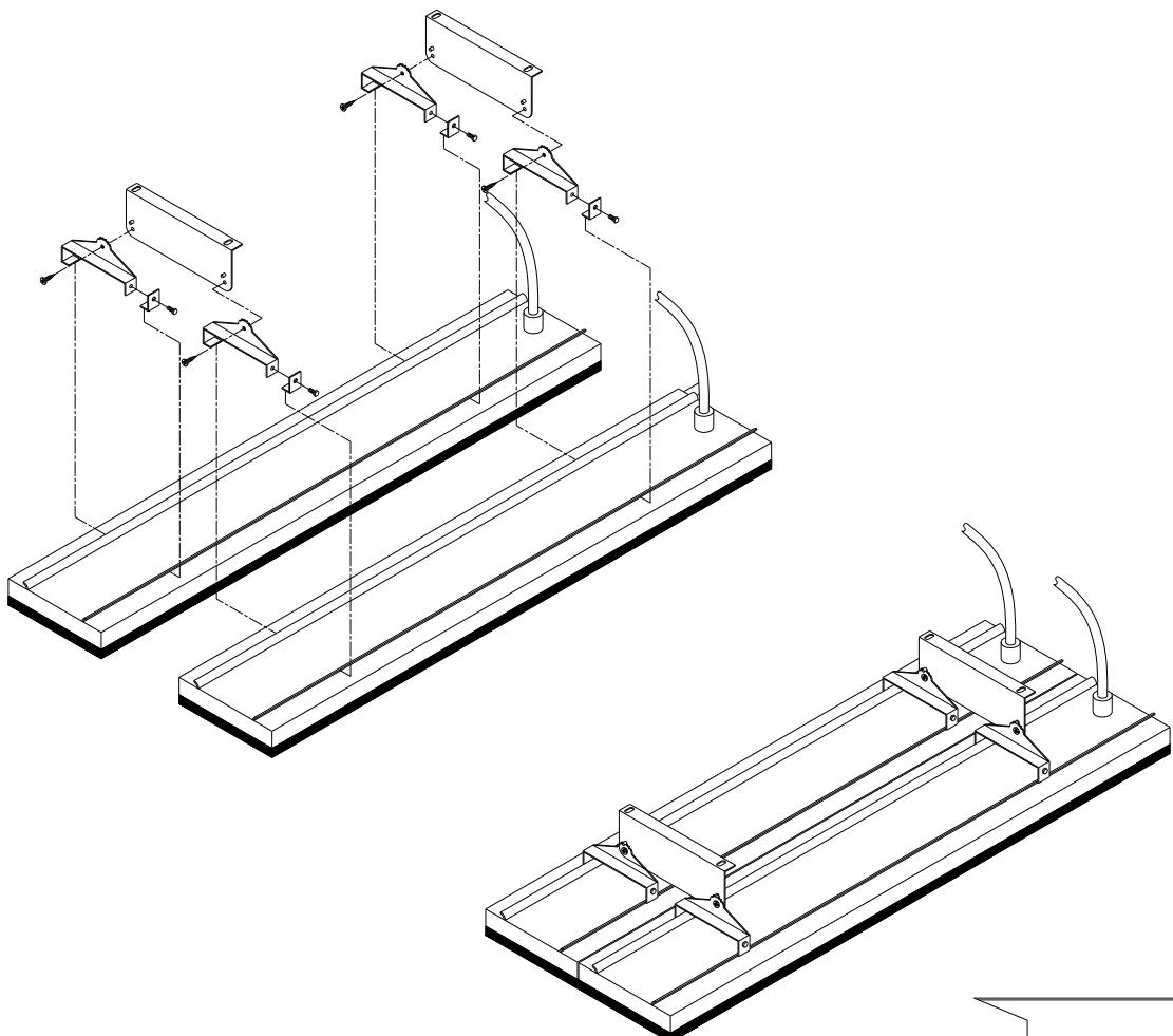
Met de optionele dubbele montagebeugel kunnen twee HEATSTRIP Design-units parallel of schuin naast elkaar bevestigd worden, zoals in het diagram rechts. Dit is ideaal voor toepassingen waar meer warmtedekking vereist is of indien er beperkingen zijn omrent de installatie (zoals tussen twee rijen tafels, etc.).
