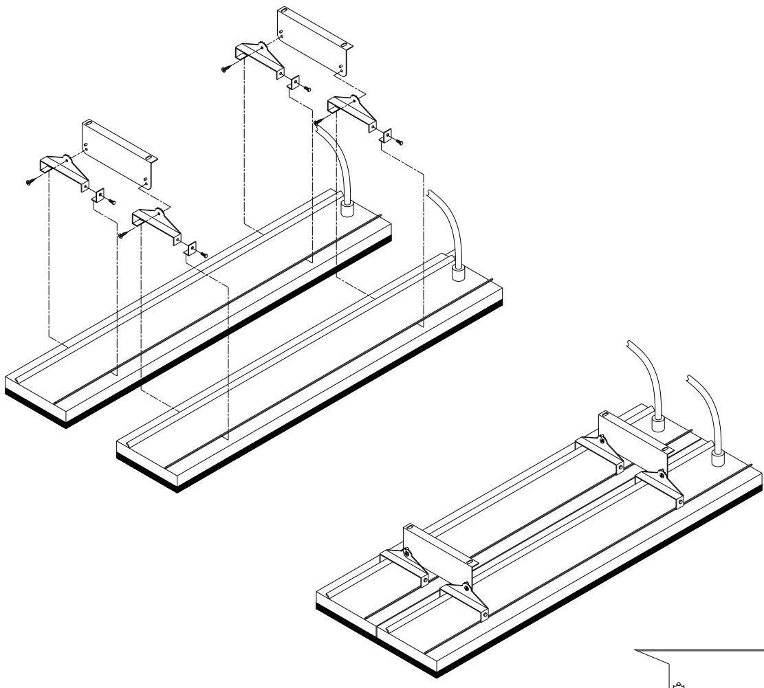
Mit dem als Option erhältlichen Duo-Befestigungsbügel können (2) Geräte des HEATSTRIP Design nebeneinander - entweder parallel oder geneigt, wie dies auf der Abbildung rechts gezeigt wird - angebracht werden. Dies ist ideal für Situationen, in denen eine größere Wärmeabstrahlung benötigt wird oder wenn es Beschränkungen bei der Montage gibt (wie bei Durchgängen zwischen 2 Tischreihen).
